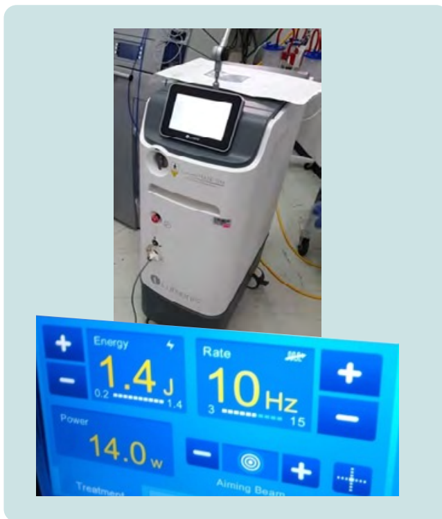
Imagen 4. Equipo láser Holmus y parámetros utilizados con una fibra láser 365.
